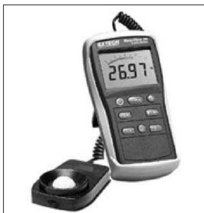
Luksmeter kojim je izvršeno merenje je Extech Instruments Easy View Digital Light Meter model EA30 (*slika 2*). Model EA30 ima opseg merenja od 40 lux do 400 klux.
