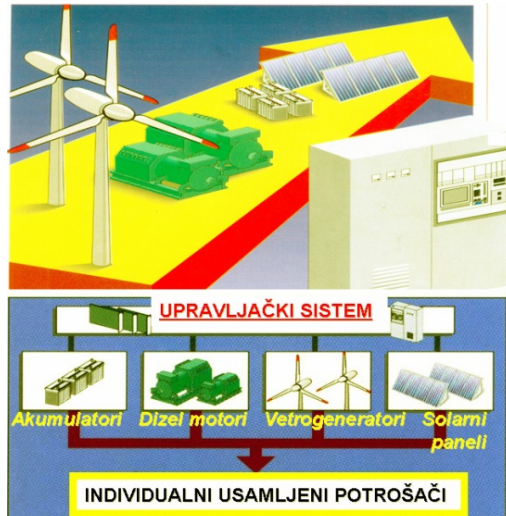
Sl. 9 Inteligentni sistemi podrazumevaju racionalno sprezanje izvora energenata Fig. 9 Intelligent systems imply rational coupling of energy sources
