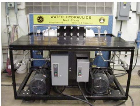
**Slika 1.** Ispitni sto komponenata vodene hidraulike [7]
