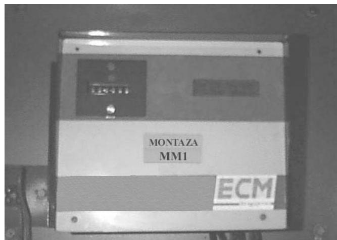
Slika. 3 Jedinica za merenje, obradu i prikazivanje rezultata
