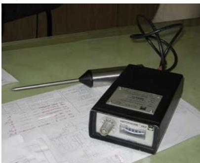
Slika 3 Ultrazvučni testeri sa a) zvučnim izlazom, b) indikatorom
