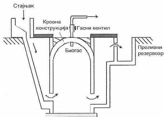
Слика 6. Шематски приказ конструкције дигестора са фиксном кровном конструкцијом
