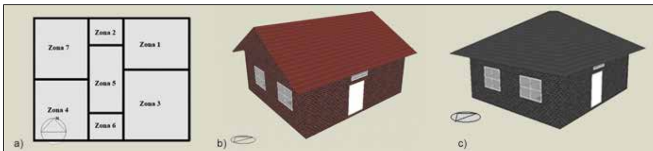
Slika 1. Geometrijske karakteristike analiziranog stambenog objekta; a) plan osnove objekta, b) objekat sa krovom na dve vode; c) objekat sa krovom na četiri vode
