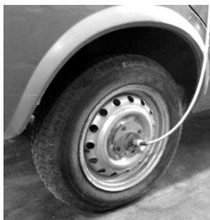
Sl. 3. Detalj davača ugaone brzine točka.
