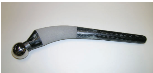
Slika 11. Veštački kuk od kompozitnog materijala
