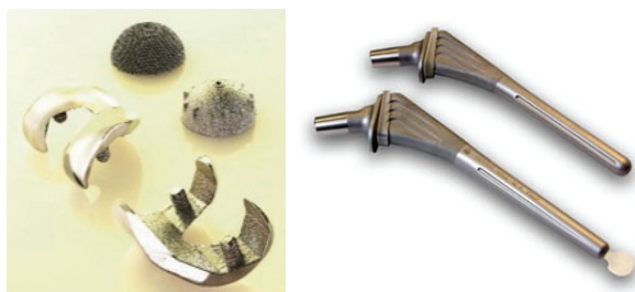
Slika 5. Delovi veštačkog kolena i kuka napravljeni od Co-Cr superlegure
