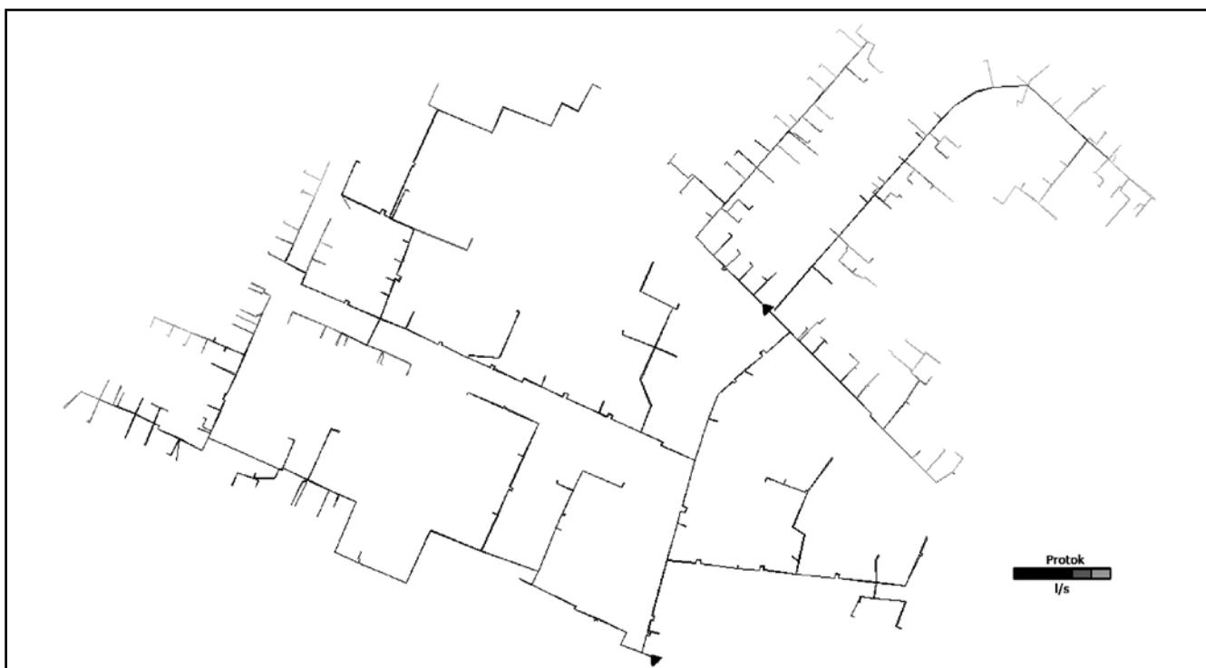
Slika 11. Vizuelizacija rezultata simulacije hidrauličkog ponašanja celokupnog TDS-K pod sistema „Erdoglija“ u kome je pored centralne pumpne stanice u izvoruštu toplove locirana i jedna cirkulaciona pumpa u razvodnoj mreži
