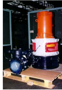
Sl. 8. Spoljašnji izgled MHE sa turbinom Peltonovog tipa
