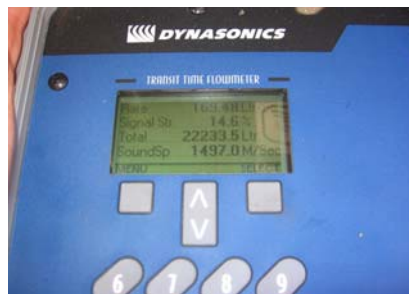
Sl. 5. Izmereni protok vode Q = 169,48 \text{ lit/s} u trenutku t_1 na jednom od mernih mesta
