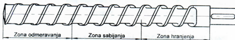
Slika 3. Karakteristične zone na ekstruzionom pužu
