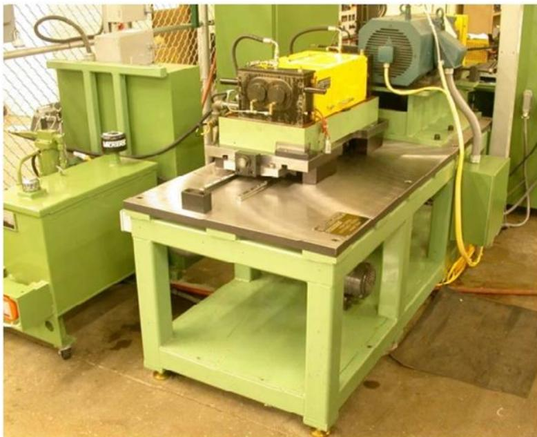
*Slika 6. Uređaj za ispitivanje stepena iskorišćenja zupčanika sa velikim brojem obrtaja*
