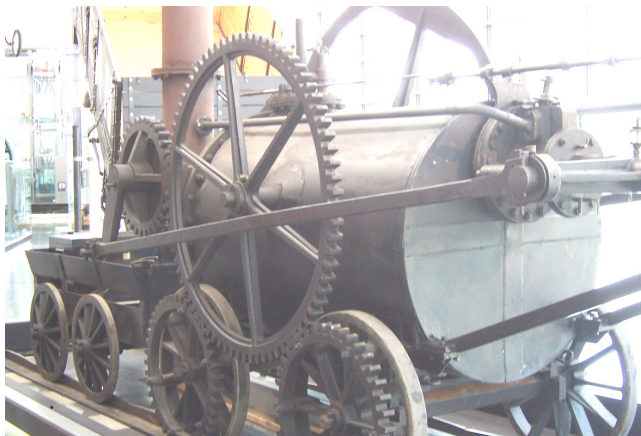
Слика 4. Прво парно возило на шинама „Invicta”- (Непобедива), које је конструисао Р. Тревитик 1804. године
