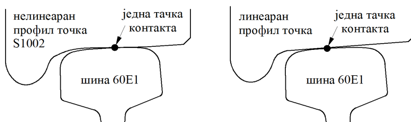
Слика 12. Контакт преко површине котрљања – једна тачка контакта
