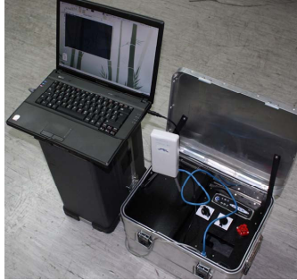
Slika 6. Računarski modul na izdvojenom mestu van kompozicije sa mernim vagonom
