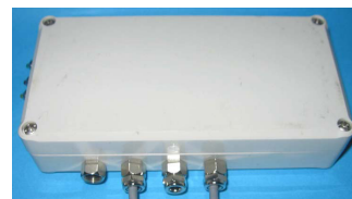
Slika 5. Elektronski radio modul kojim se prenose merni signali sa rotirajuće osovine
