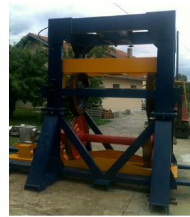
Slika 12. Probnica za kalibraciju i ispitivanje seta mernih osovinskih sklopova
