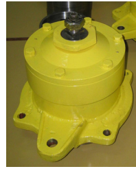
Slika 8. Pretvarač za merenje bočne sile
