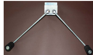
Slika 9. Pretvarač za merenje visine odizanja točka
