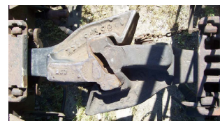
Slika 10. Automatsko kvačilo tipa SA-3
