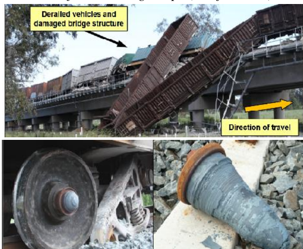
Slika 3 - Detalji iskliznu a uzrokovanog otkazom ležaja osovinskog sklopa (Australija, 2010.) [7]
