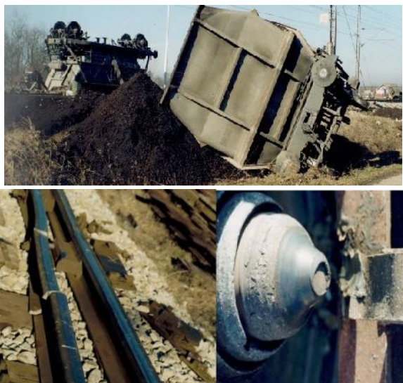
Slika 2 - Detalji iskliznu a uzrokovanog otkazom ležaja osovinskog sklopa (Srbija, 1995.)
