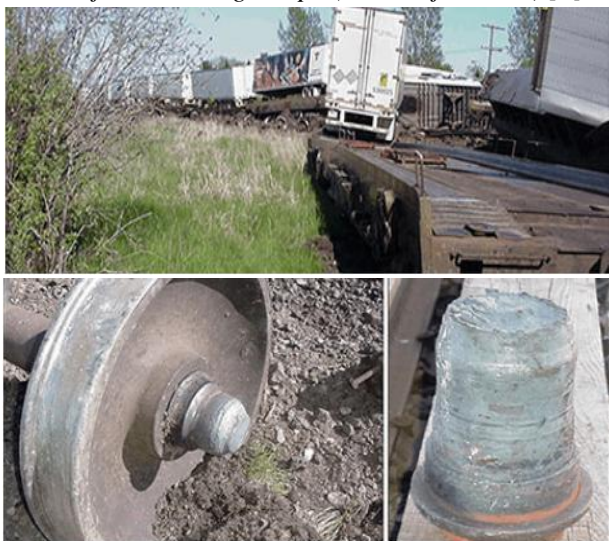
Slika 4 - Detalji iskliznu a uzrokovanog otkazom ležaja osovinskog sklopa (Kanada, 2003.) [8]
