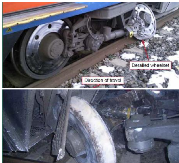
Slika 5 - Detalji iskliznu a uzrokovanog otkazom ležaja osovinskog sklopa (Engleska, 2010.) [9]
