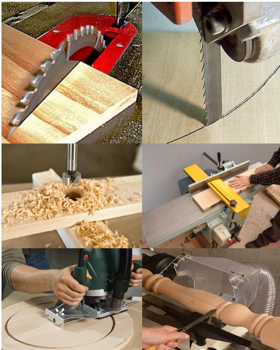
**Slika 2.8** Operacije mašinske obrade drveta: sečenje (kružnom i trakastom testerom), bušenje, rendisanje, glodanje, struganje
