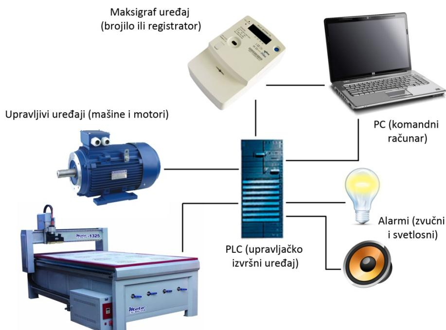
Slika 3.6 Princip korišćenja računarskog sistema upravljanja opterećenjem
