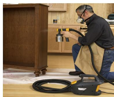
**Slika 2.20** Nanošenje premaza pištoljem
