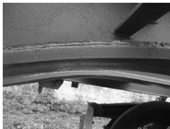
Slika 7: Prslina na srednjem podužnom nosaču vagona Figure 7: Crack on longitudinal carriage of wagon
