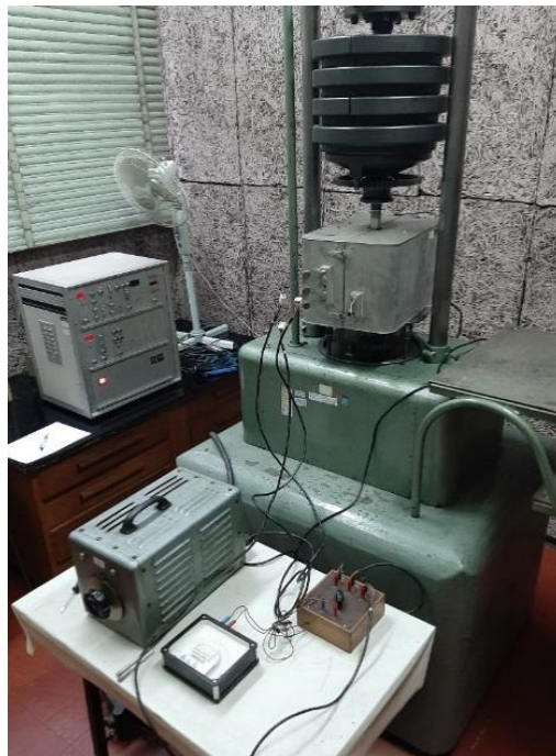
Slika 5. Postupak ispitivanja zamornih karakteristika materijala na povišenoj temperaturi
