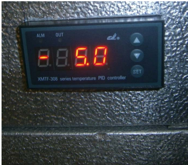
Слика 3. Сензор за одржавање температуре унутар тест коморе
