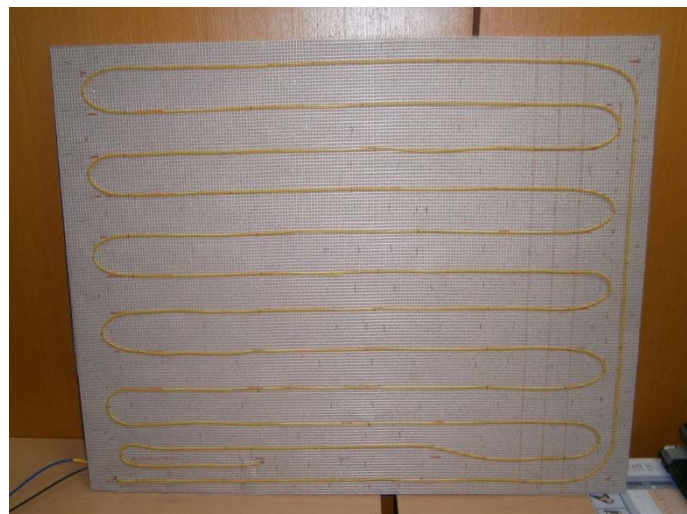
Слика 7. Детаљ монтаже ЕГК у конструкцији ПСГ
