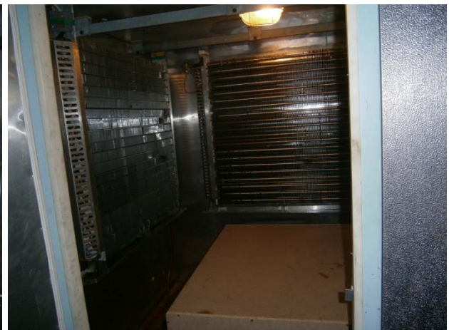
Слика 2. Рахладна тест комора са приказом испаривача
