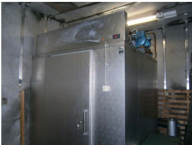
Слика 2. Рахладна тест комора са приказом испаривача
