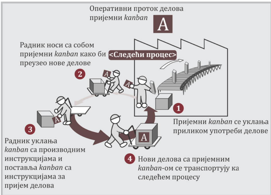
Слика 11.3 Начин организовања производње применом Kanban -а (factsanddetails.com)
