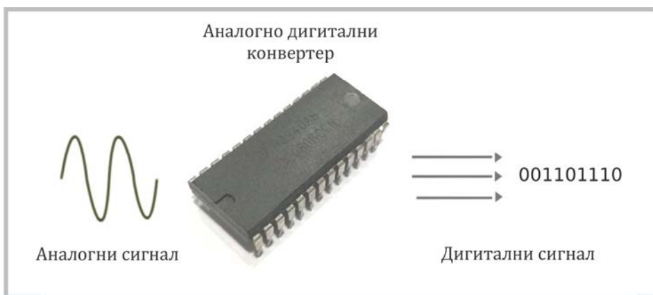
Слика 11.6 A/D конвертер (преузето са веб странице: https://components101.com/articles/analog-to-digital-adc-converters )
