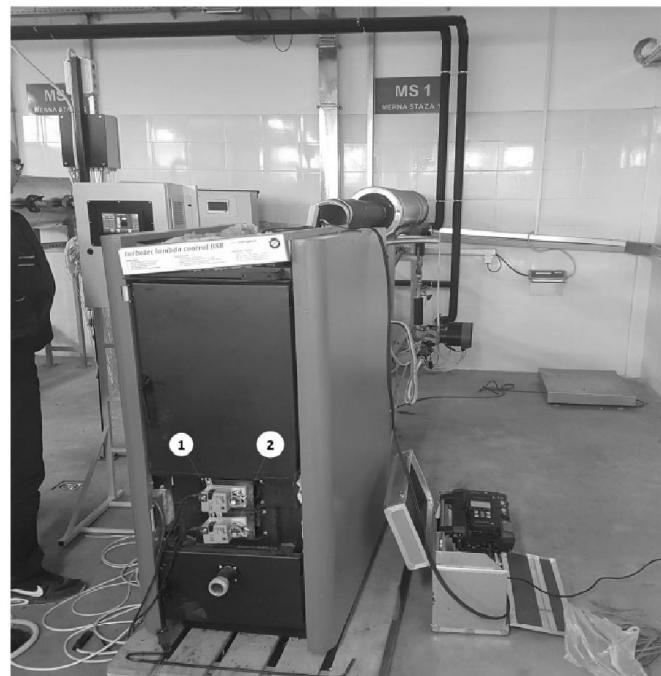
Slika 2: Detalj sa ispitivanje toplovodnog gasifikacionog kotla.
