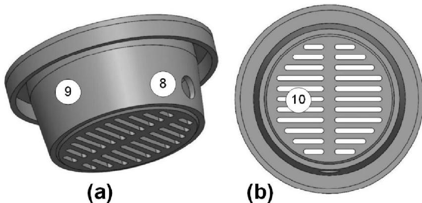
Слика 2. Изглед претходне шоље горионика. (а) изометријски приказ, (б) поглед одозго.
