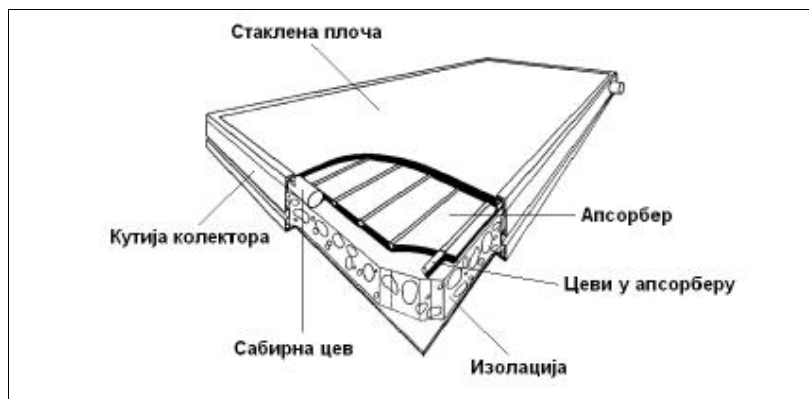
Слика 3.1 - Пресек равног застакљеног колектора
