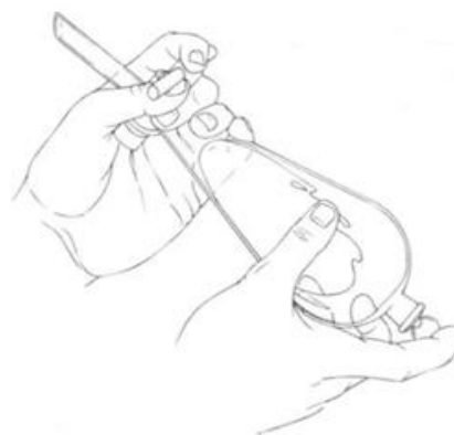
Slika 35. Pravilno korišćenje levka za odvajanje
