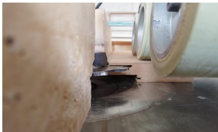
Slika 10. Podešavanje alata šablonom
