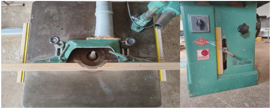
Slika 11. Podešavanje alata po širini i visini
