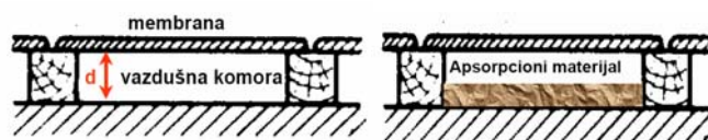
Слика 3. Механички апсорбери без и са апсорпционим материјалом
