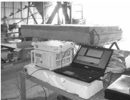
Foto 1 – Dispozicija ispitivanih elemenata i merna stanica (MGCplus i SPIDER 8 povezani na PC Notebook).
