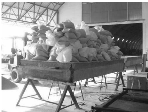
Foto 2 – III faza opterećenja ( q_{max} = 720 \text{ daN/m}^2 ).
