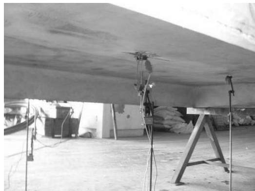
Foto 3 – Instrumentacija ferocementnog elementa (Induktivni davači pomeranja U5, U6 i ugibomer U7, merne trake na čeliku MT6 i MT7 – (Uzorak 2).
