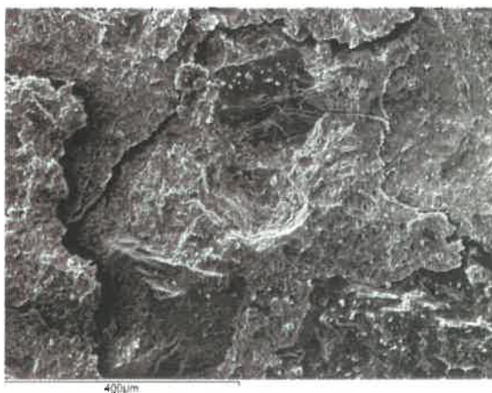
Slika 9. Mikrostruktura betona sa mlevenim krečnjakom Figure 9. Microstructure of the concrete with lime
