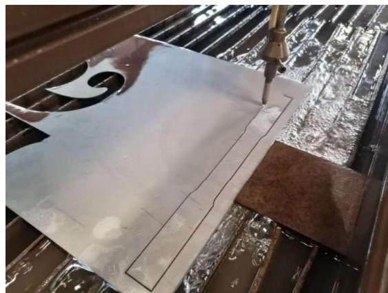
Slika 6. Izrada epruveta vodenim mlazom
