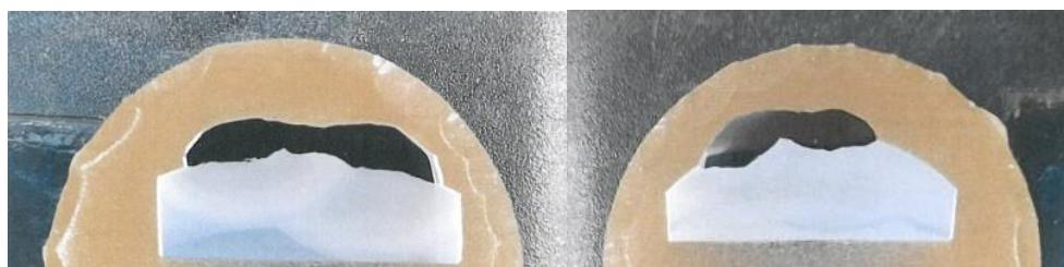
Slika 11. Izgled nekih pripremljenih metalografskih izbrusaka
