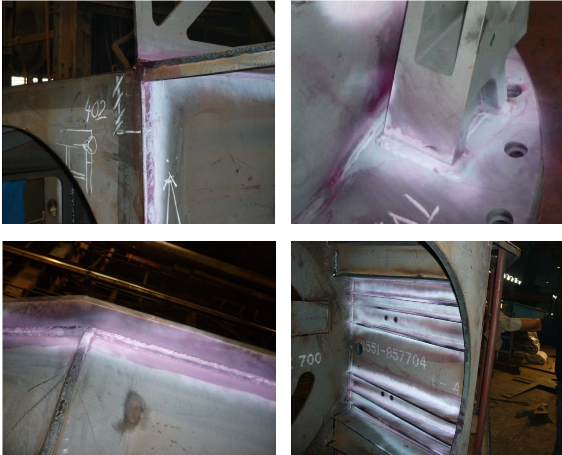
Слика 6.6 Пример пенетрантне контроле на реалним деловима
