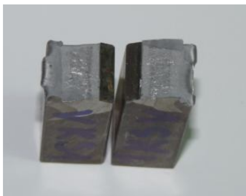
Слика 5.29 Изглед места прелома: корен зона стапања – плоча 1 – узорак 1
