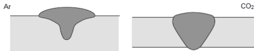
Слика 4.6 Разлика у облику шави у зависности од заштитног гаса
