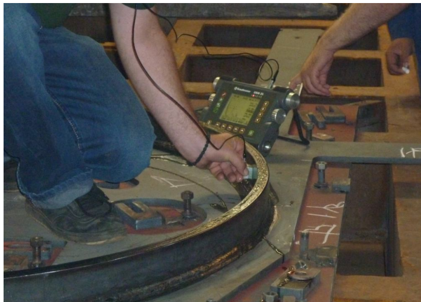
Слика 6.7 Пример извођења ултразвучне контроле на реалним деловима
