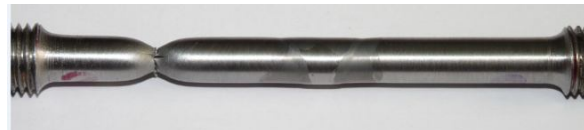
Епрувета после испитивања затезањем - ЗС
