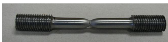
Епрувета после испитивања затезањем - ОМ
