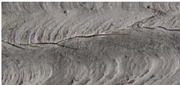
Слика 3.3 Макрографски приказ хладне прслине у металу шави
