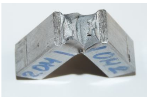
Слика 5.10 Изглед места прелома - ОМ - узорак 1 – плоча 2 (МИГ/МАГ)
