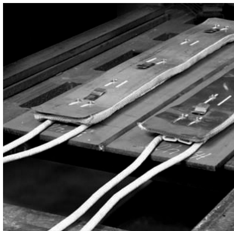
Слика 4.3 Постизање и одржавање температуре предгревања електричним грејачима
