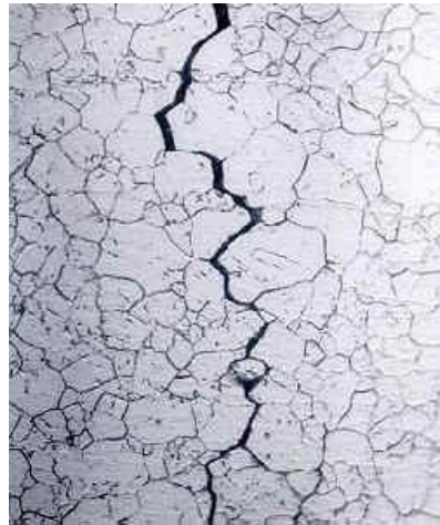
Слика 3.2 Микрографски приказ хладне прслине
