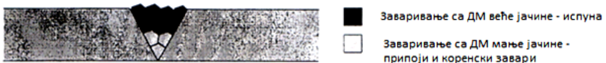
Слика 4.3 Вишеслојно заваривање различитим додатним материјалима
