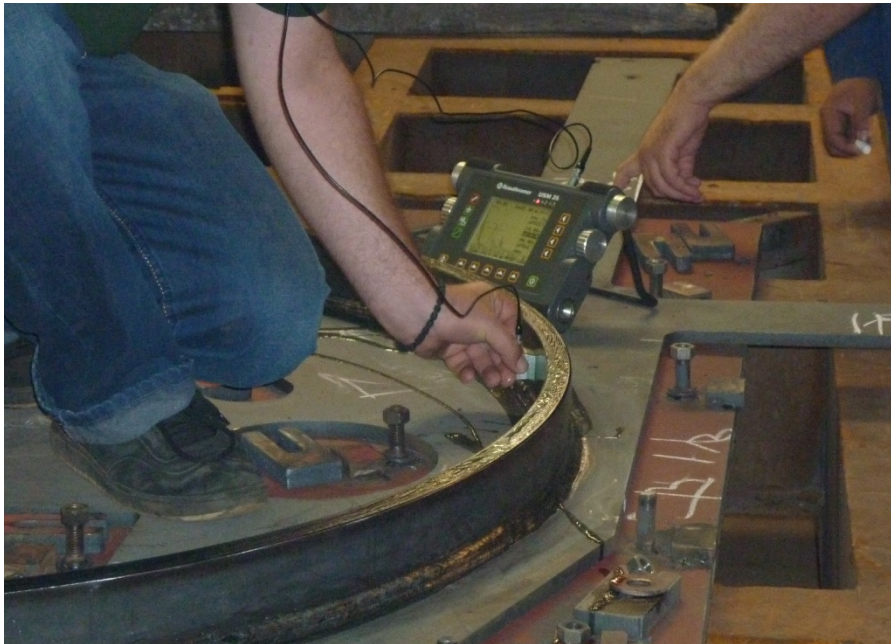
Слика 6.18 Ултразвучна контрола
