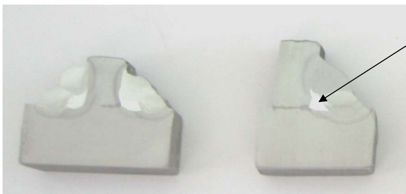
Слика 5.6 Макроскопски изглед угаоног споја
