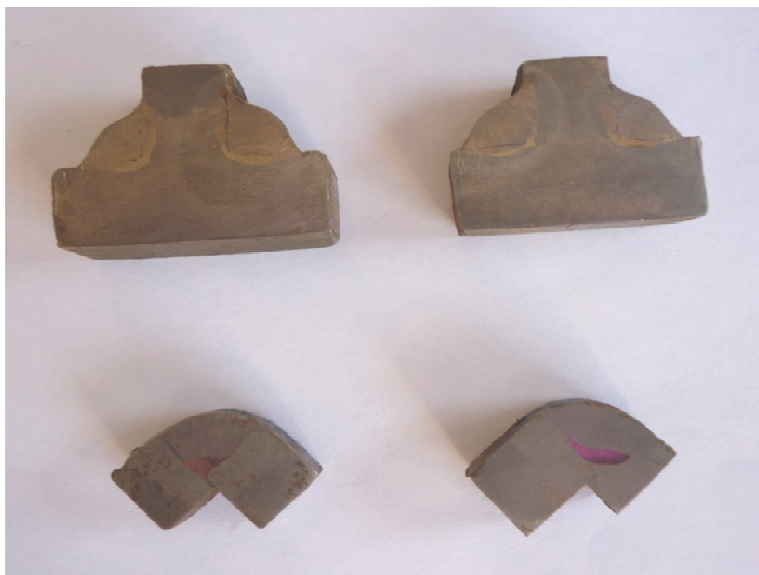
Слика 5.12 Макроскопски снимак угаоно заварених спојева
