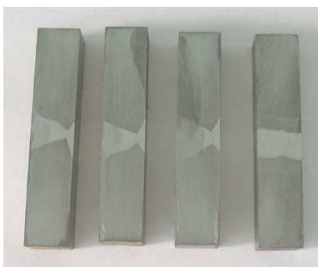
Слика 6.16 Епрувета за испитивање ударом – заварени спој
