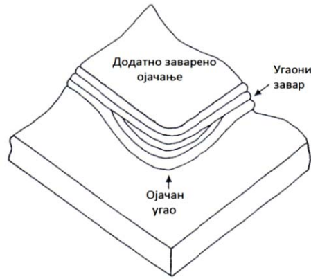
Слика 4.6 Пример побољшања угаоне геометрије
