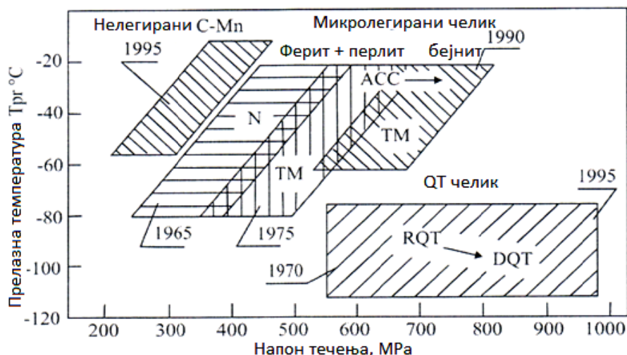
Слика 2.5 Однос напона течења и прелазне температуре крости челика добијених различитим поступцима обраде: N - нормализација, TM - термомеханичка прерада, ACC - убрзано хлађење, QT - каљење и отпуштање.
