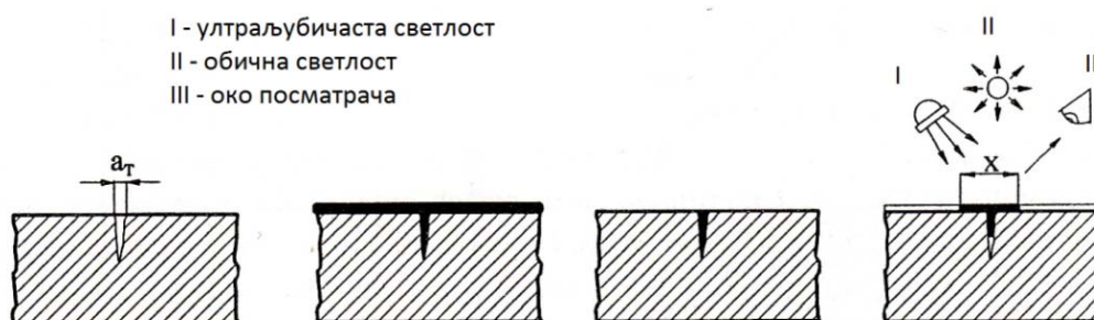
Слика 6.7 Схема капиларне дефектоскопије
