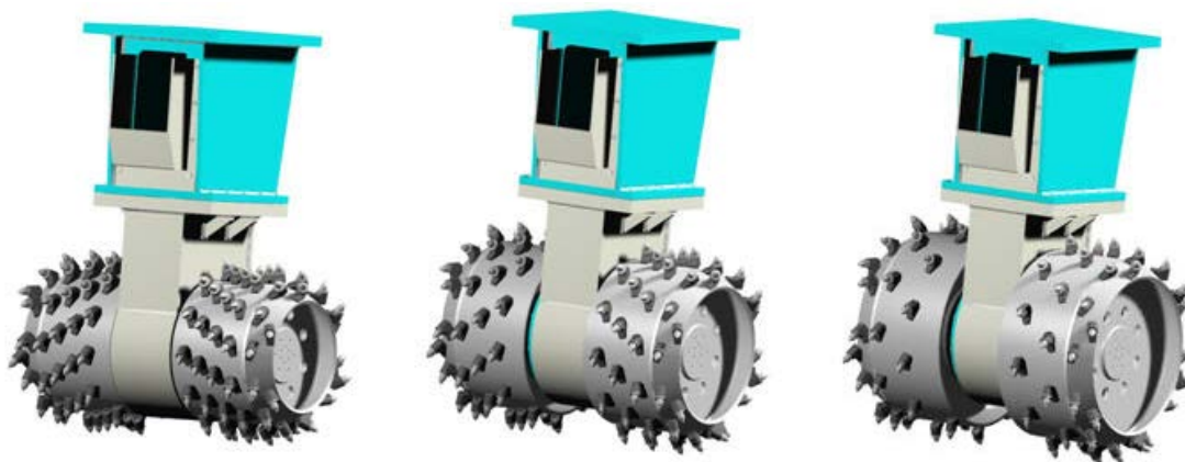
Slika 4. Familija sistema glodačkih glava [4]
