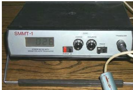
Slika 2. Uređaj za merenje zaostalih napona (SMMT-1)
