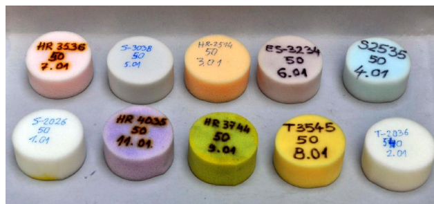
Sl. 2. Ispitivani materijali (uzorci debljine 5 cm).
