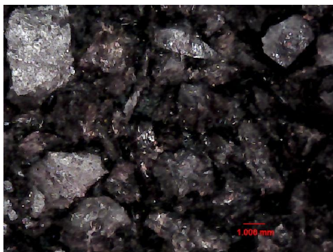
Sl. 2. Struktura uzorka od reciklirane gume (uvećanje 10 puta).
