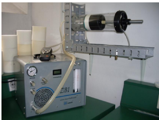
Sl. 5. Izgled mernog sistema za određivanje otpornosti strujanju vazduha.
