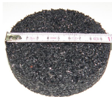
Sl. 3. Uzorak za akustička ispitivanja.
