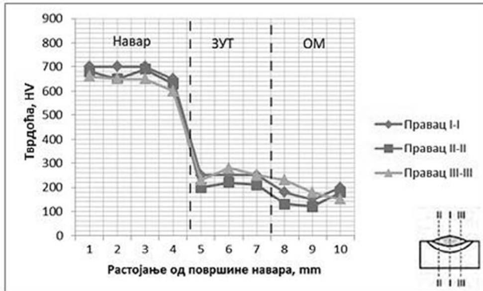
Slika 7. Raspodela tvrdoće po preseku navara: a) O.M. - S235JR, D.M. navara - FILTUB DUR 16
