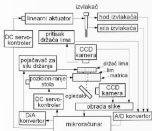
Sl.4. Šema uređaja za duboko izvlačenje vrlo tankih limova [5]
