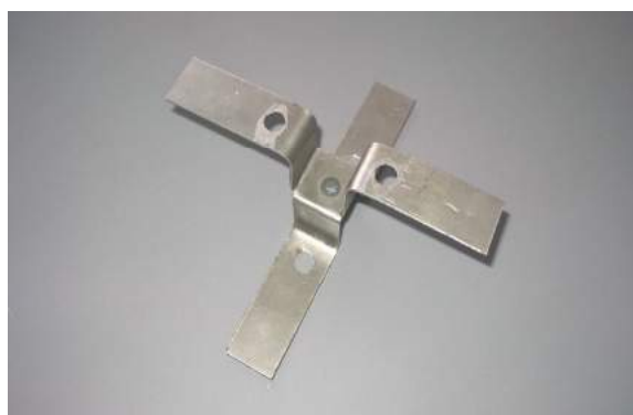
Slika 9. Izgled krstasto zavarenih uzoraka-epruveta
