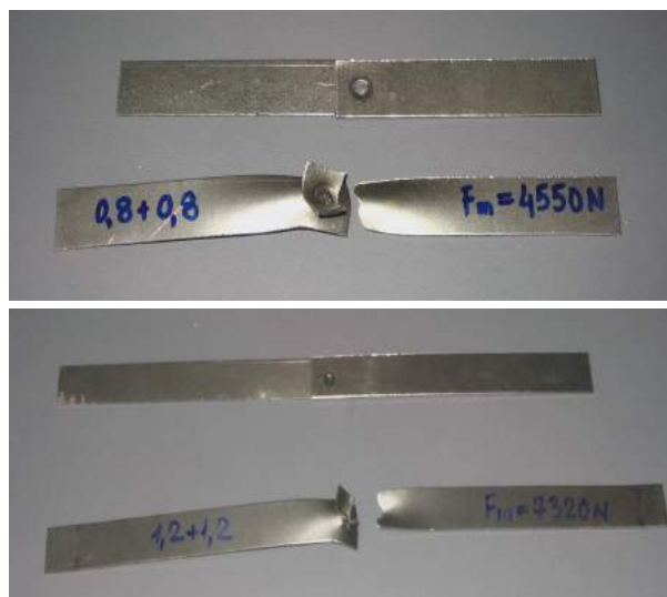
Slika 6. Izgled uzoraka-epruveta pre i posle kidanja
