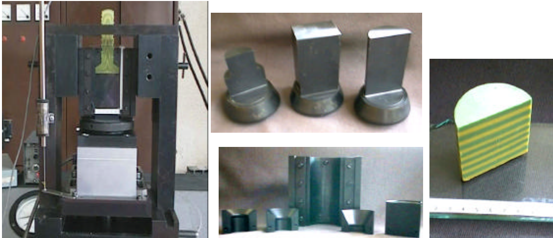
Slika 6: Uređaj za fizicko modeliranje sa lako-izmenljivim matricama i pritiskivacima, plastelinski pripremak
