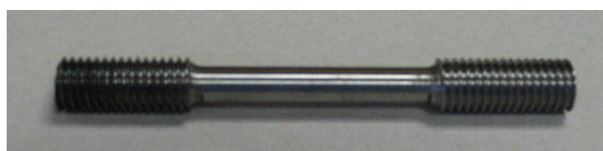
Epruveta za ispitivanje zatezanjem OM
