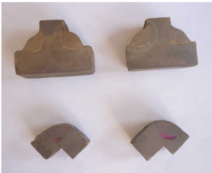
Slika 2. Makroskopski izgled zavarenih spojeva
