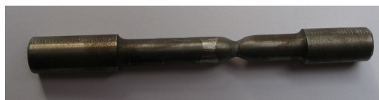
Epruveta posle ispitivanja zatezanjem ZS
