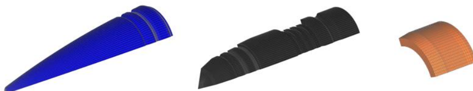
Figure 7 – FEM model of the projectile elements Рус. 7 – МКЭ модель элементов снаряда Слика 7 – МКЕ модел елемената пројектила
