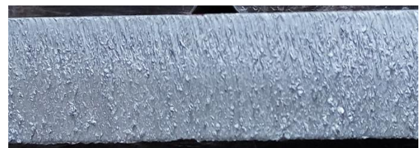
p: 6 bar, v: 2000 mm/min, I: 85 A, H: 1.5 mm
