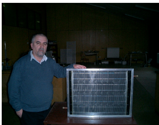
Слика 2 Хибридни пријемник SVPA: (а) Схема пресека и (б) реализован прототип
