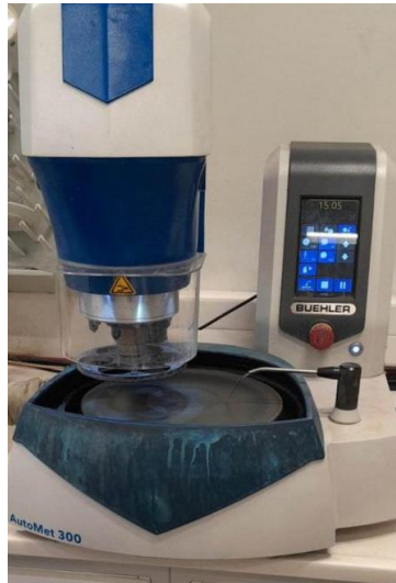
Слика 4.30. Уређај за припрему узорака AutoMet 300 Pro
