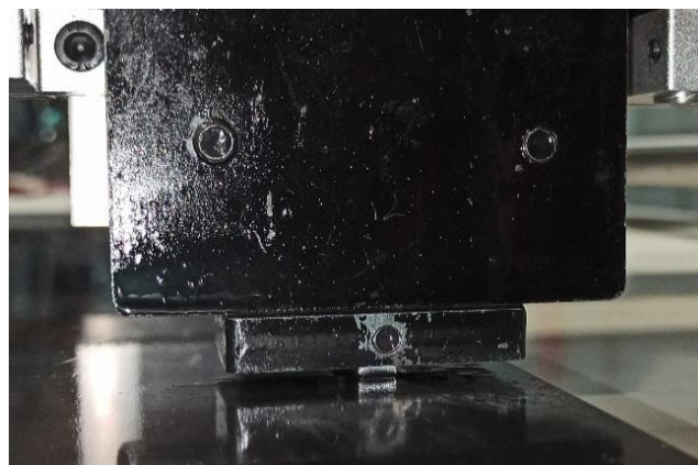
Слика 5.33. Изглед контактнoг пара код трибометра са праволинијским наизменичним кретањем
