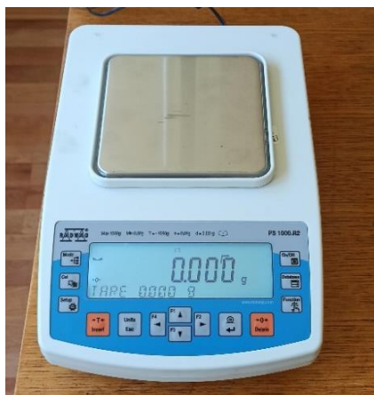
Слика 5.35. Вагица за мерење хабања „Радваг“ модел PS 1000.R2
