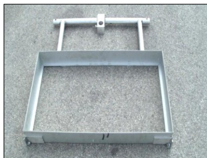
Slika 2. Nosna konstrukcija PRS (levo): 1 – konzolni nosač, 2 – osovinu sa podeonom glavom i 3 – nosač prijemnika i nosač prijemnika (desno)
