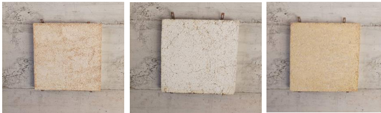
Слика 125. Биокомпозицији П, К и М као изолациони материјали на фасадном зиду од беџона, њихова димензија 500 x 500 mm
