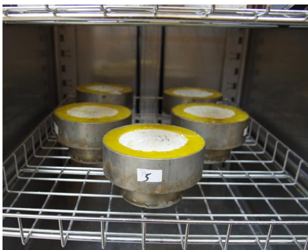
Слика 83. Посуда са узорком за испитивање отпора дифузији водене паре
