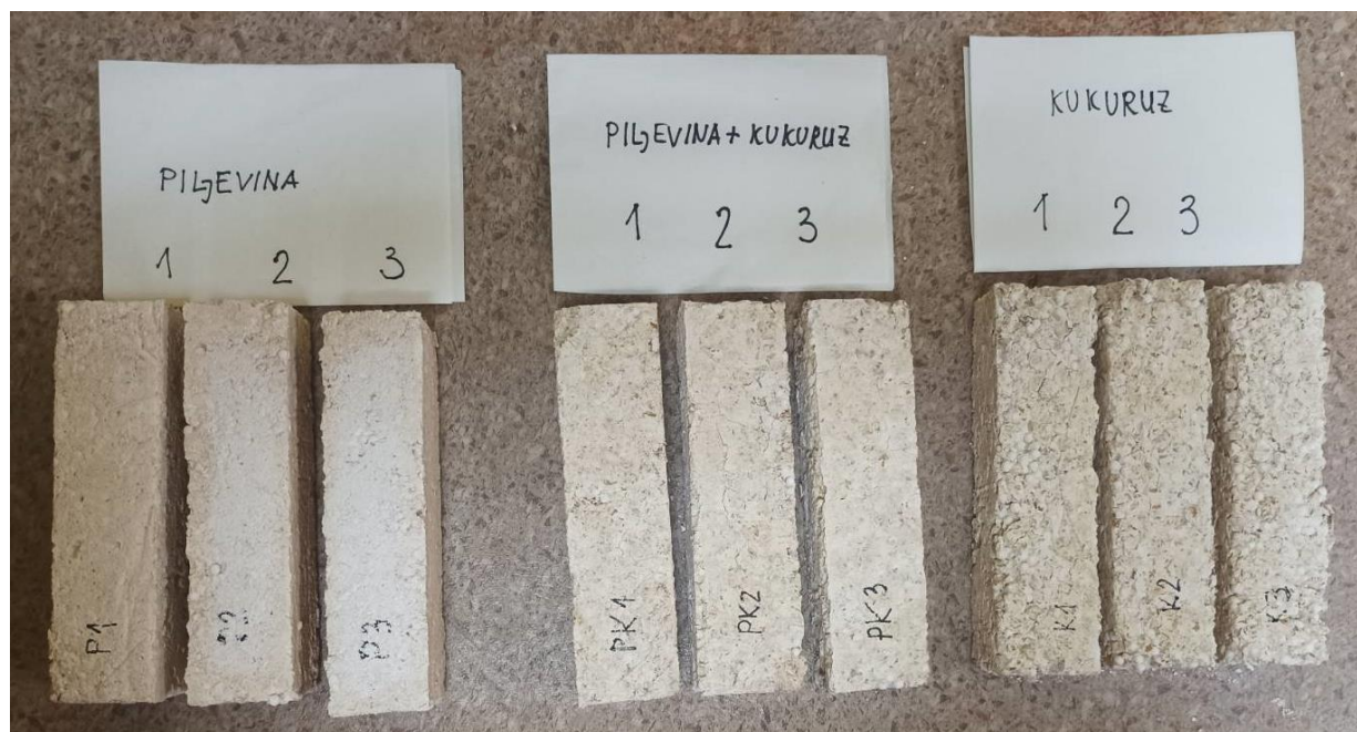
Слика 77. Узорци за испитивање чврстоће при притиску
