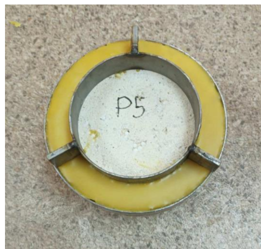
Слика 83. Посуда са узорком за испитивање отпора дифузији водене паре
