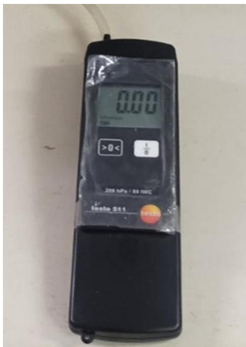
Слика 72. Диференцијални мерач TESTO 511
