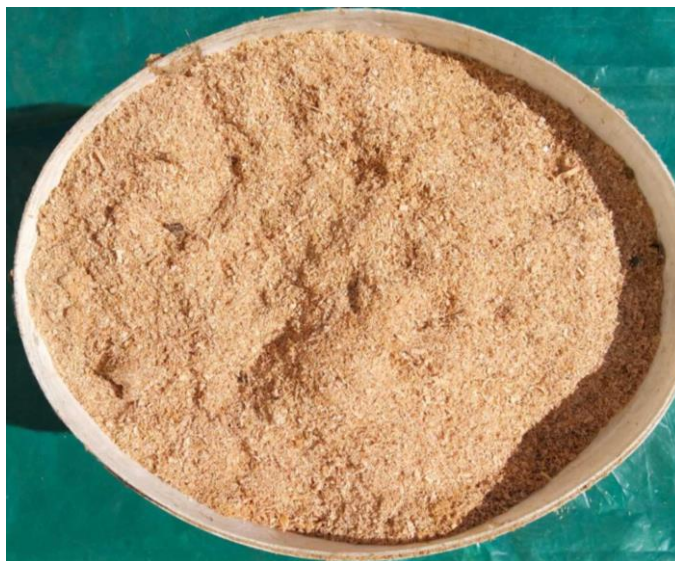
Слика 61. Букова пиљевина коришћена за прављење узорака
