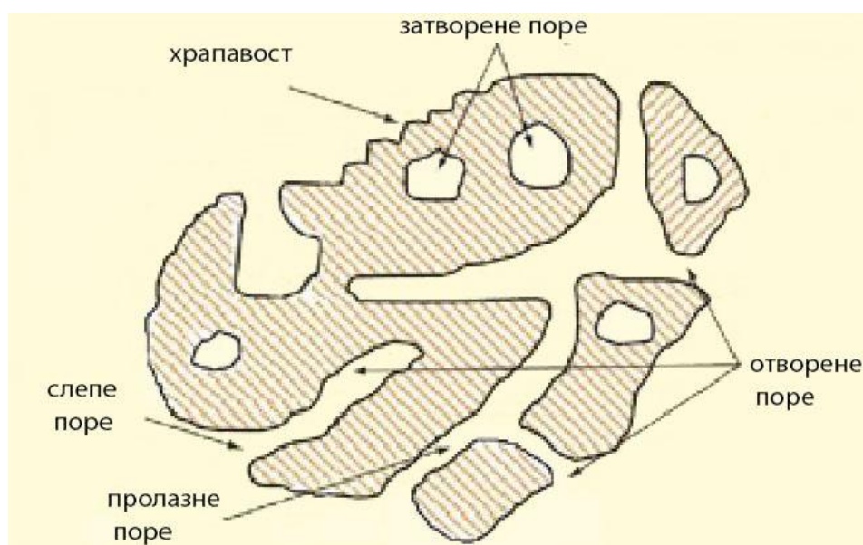
Слика 45. Графички приказ пресека порозног чврстог материјала [102]
