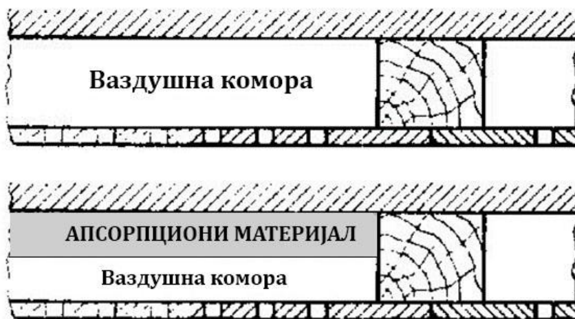
Слика 42. Акустички резонатор са и без апсорпционог материјала [75]
