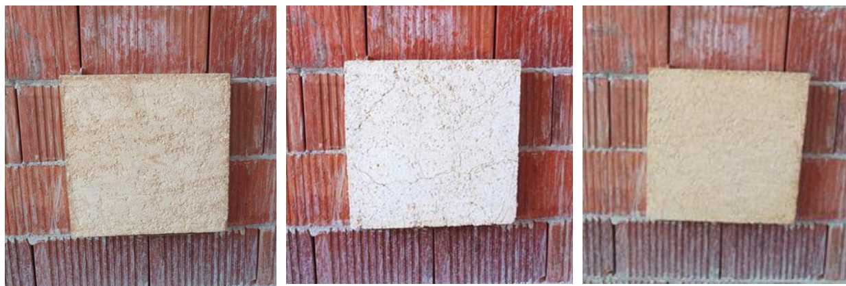
Слика 124. Биоккомпозити П, К и М као изолациони материјали на фасадном зиду од грађевинског блока, плоча димензија 500 x 500 mm
