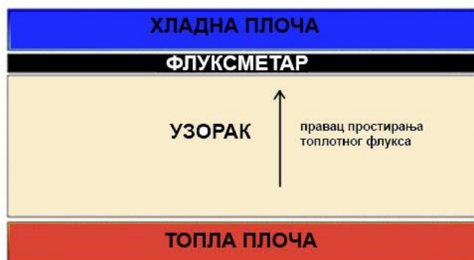
Слика 16. Шематски приказ методе са флуксметром
