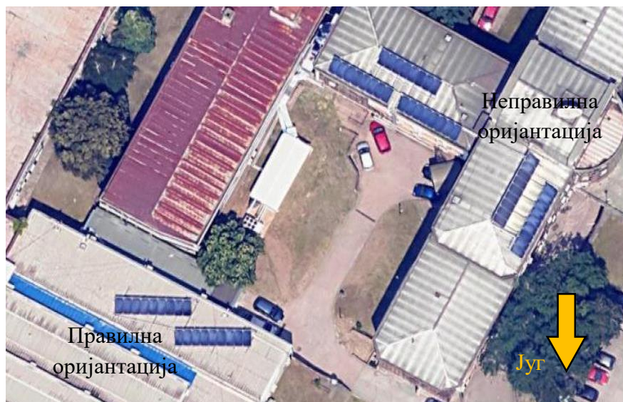
Слика 1. Пример добре и лоше праксе уградње соларних пријемника за загревање топле потрошне воде на територији града Крагујевца.
